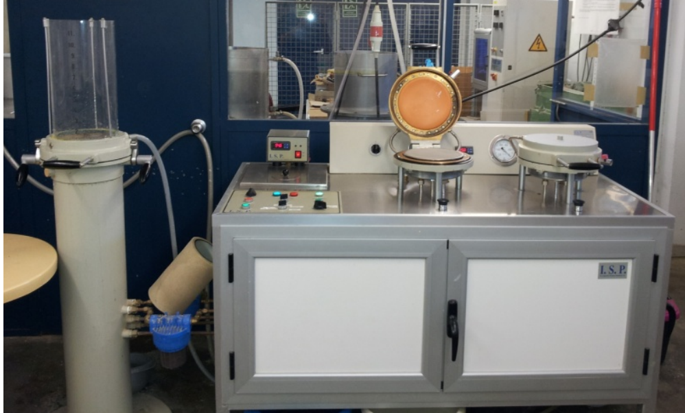
Figura 3. Equipo para la fabricación de papel a escala de laboratorio
