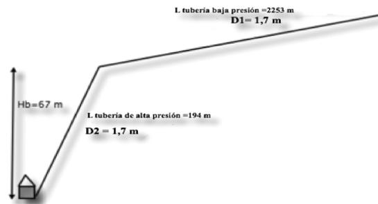
*Ilustración 15. Esquema general de la conducción por tubería para el proyecto PCH río Claro*
