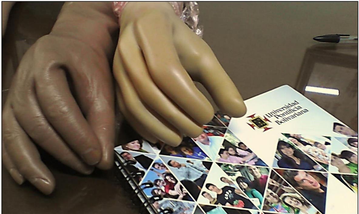
**Figura 18. Prótesis mecánica y su respectivo guante cosmético. Acceso a los dispositivos cortesía de la ortopedia Cenop.**
