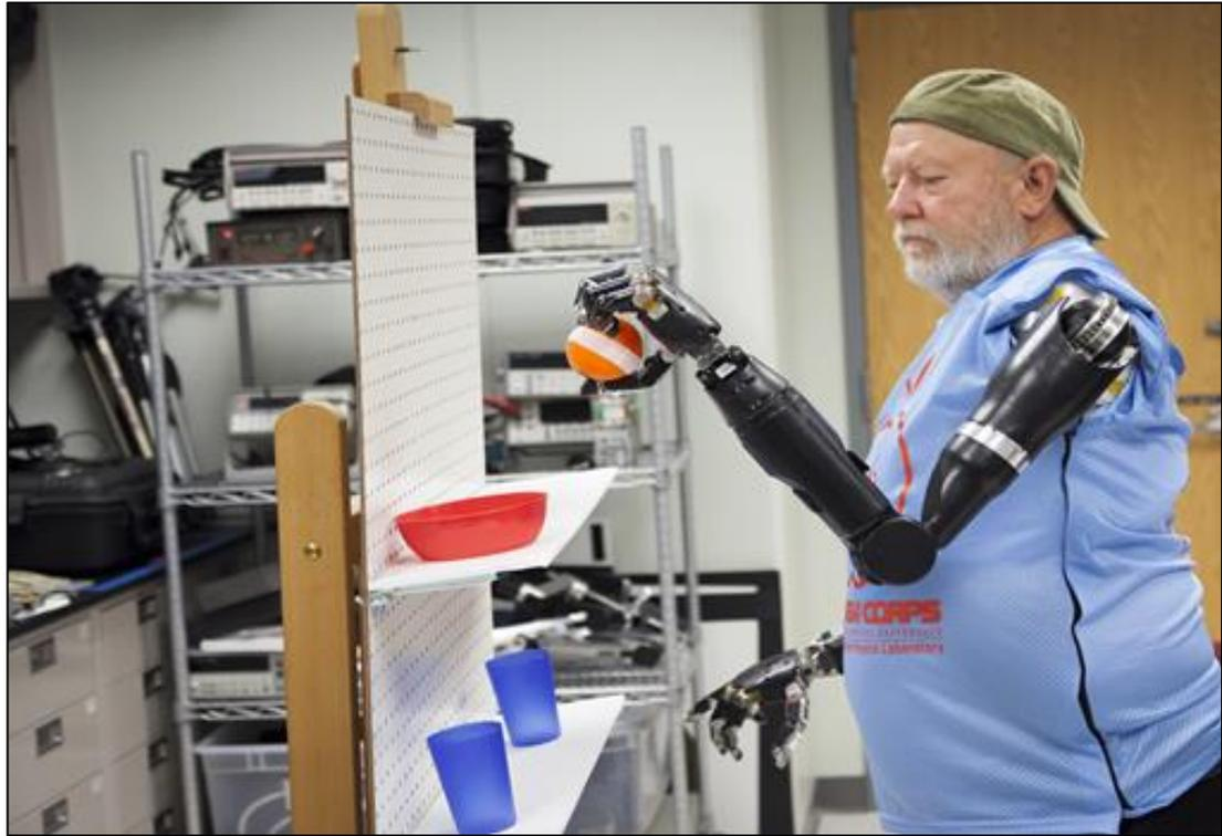
**Figura 15. Paciente con doble amputación de nivel alto controlando simultáneamente dos prótesis MPL mediante TMR. Imagen tomada de [59]**
