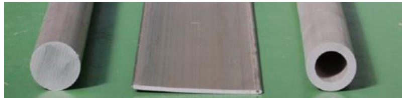
Figura 2. Geometrías obtenidas mediante extrusión de magnesio [8].
