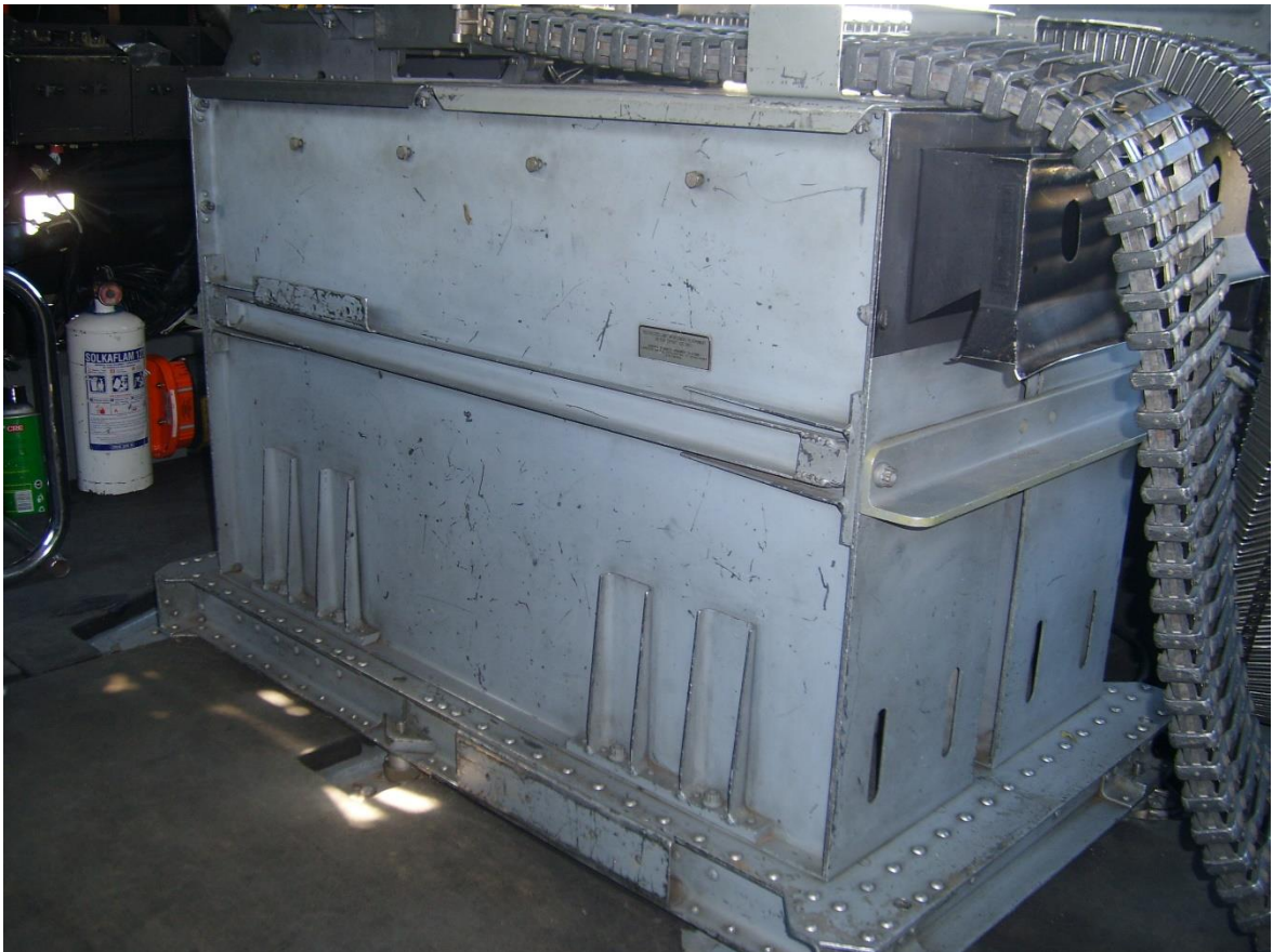
Figura 35. Caja de munición y su correspondiente soporte instalados en la aeronave.
