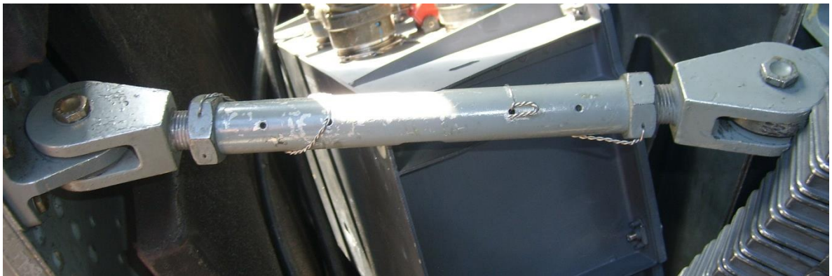
Figura 51. Soporte auxiliar de la ametralladora instalado en la aeronave.
