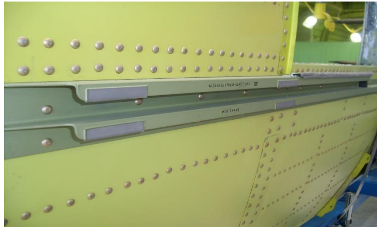
Figura 58. Fotografía del riel de la puerta de entrada.
