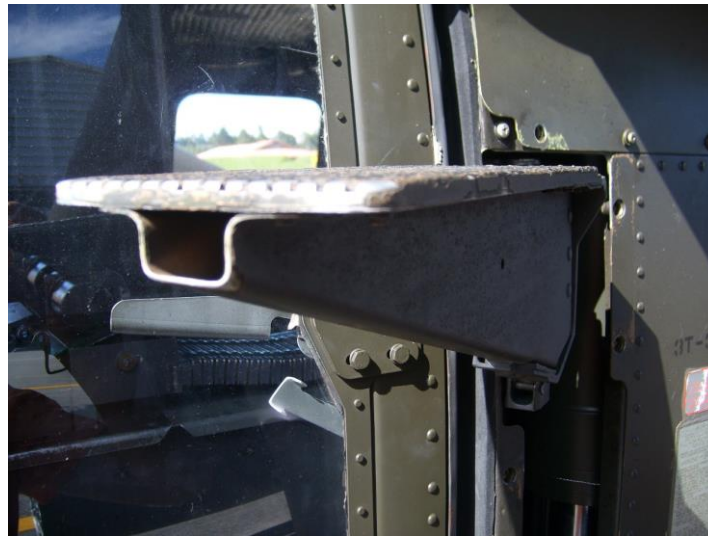
Figura 1. Pie de apoyo instalado en la aeronave.
