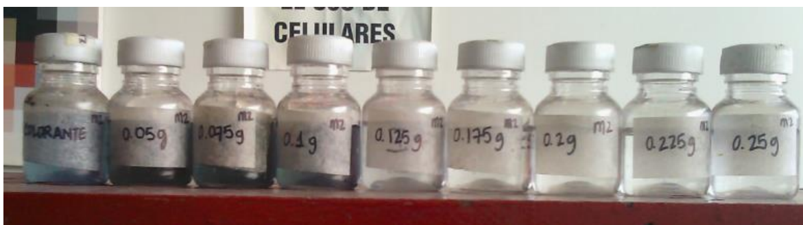
Figura 6. Efecto del carbón activado obtenido a partir de neumáticos usados sobre la remoción de índigo carmín.
