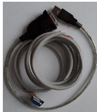
Figura 10. Cable USB-serial.
