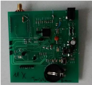
Figura 12. Prototipo medidor de la CPE.
