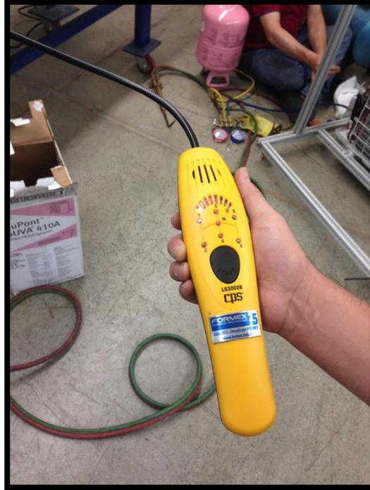
*Ilustración 18. Chequeador de fugas CPS LMS 3000 DB. (Tomado por los autores)*
