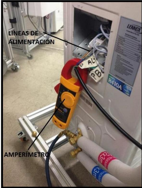
*Ilustración 27. Monitoreo de la corriente consumida por el Mini Split (Tomado por los autores)*
