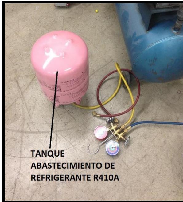
*Ilustración 26. Abastecimiento del refrigerante R410A en estado líquido
