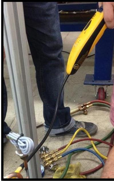
*Ilustración 19. Chequeo de fugas. (Tomado por los autores)*
