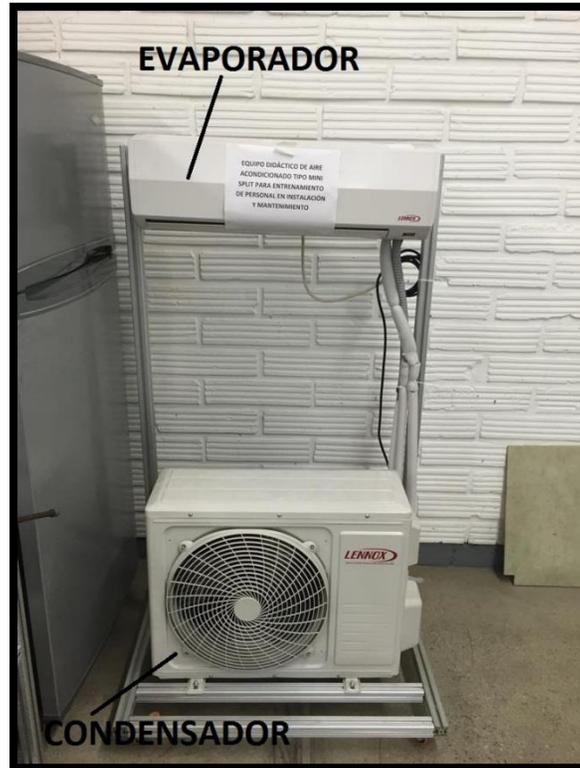
*Ilustración 13. Montaje del Mini Split en el chasis (Tomado por los autores)*
