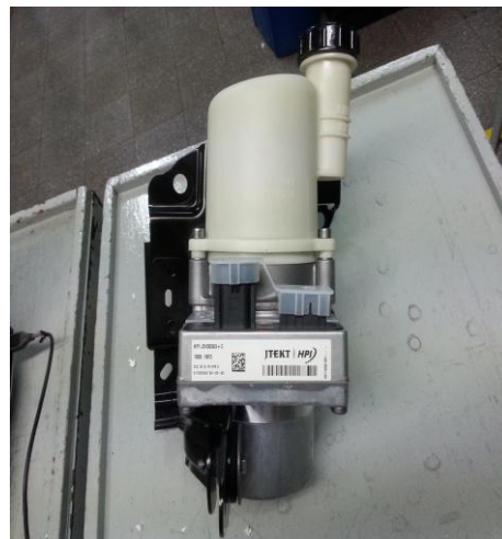
Figura 6. Bomba de dirección electro-hidráulica que se usará en el VE
