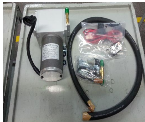
Figura 8. Kit bomba eléctrica de frenado
