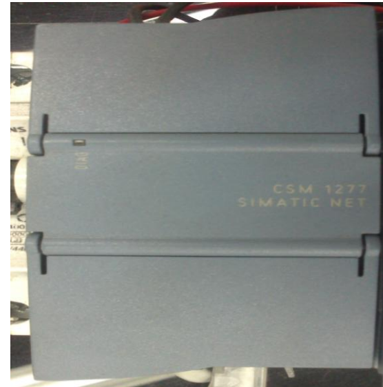
Figura 3. Visualización de conexión modulo ethernet
