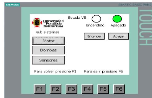
Figura 13. Imagen de selección y encendido de motor
