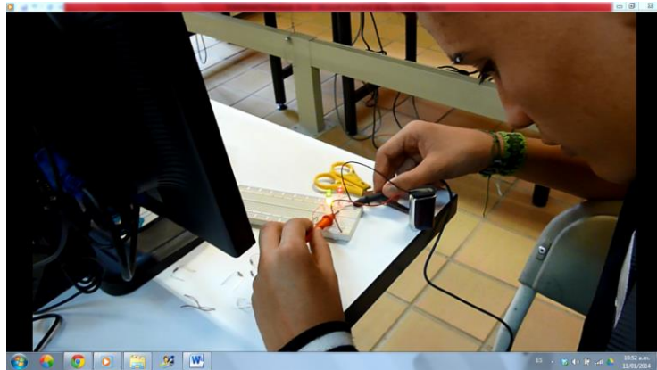
Ilustración 31. Uso de multímetro en circuito físico
