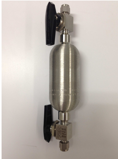
Figura 26. Tanque de carga de refrigerante
