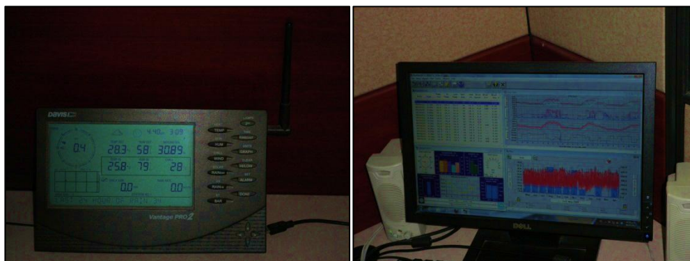
Figura 9. Colector digital de datos, programa WeatherLink 5.7. Imagen tomada en el campus UPB. 3 de Marzo de 2012.
