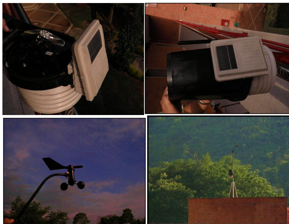
Figura 8. Pluviógrafo, sistema telemétrico con doble cubeta basculante, posee sensores que transmiten la información. Imágenes tomadas en el campus UPB. 3 de Marzo de 2012.
