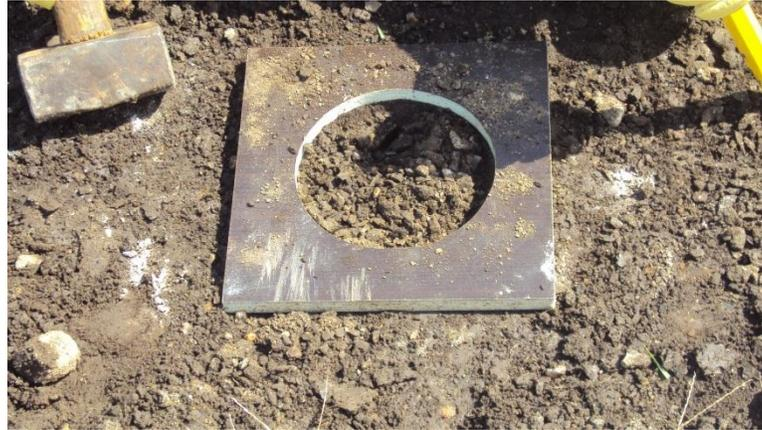
Figura 13. Colocación del molde después de nivelar el terreno
