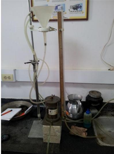
Figura 21. Ensayo permeabilidad en laboratorio.
