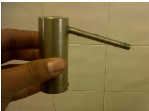
Figura 22. Cámara (Hervidor superior)
