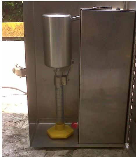
Figura 25. Tubo de descarga y bombillo indicador.
