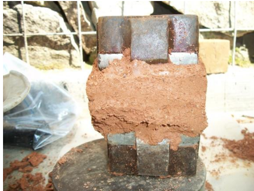
Muestras de suelo sin refuerzo para ensayo de corte directo
