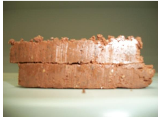
Muestra de suelo sin refuerzo fallada
