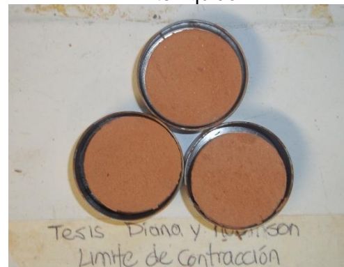
Límite de contracción
