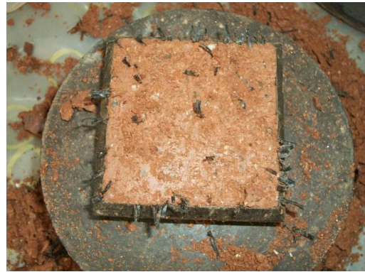
Muestra de suelo con refuerzo antes del ensayo de corte directo
