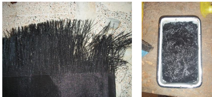
Geotextil recortado y almacenado
