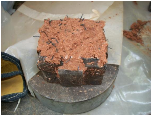
Muestra de suelo con refuerzo sin enrazar para ensayo de corte
