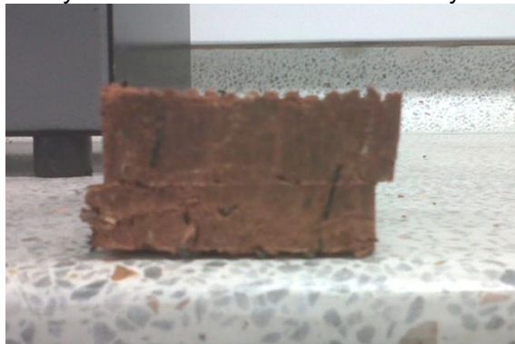
Muestra de suelo con refuerzo fallada
