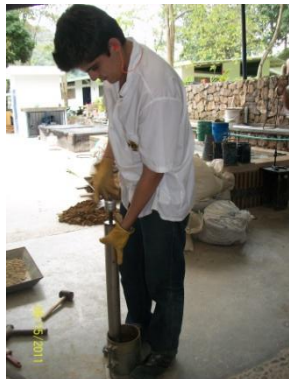
Figura 11. Ensayo de proctor.
