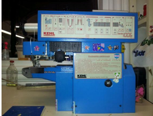
Imagen 4: Máquina dobladora digital.
