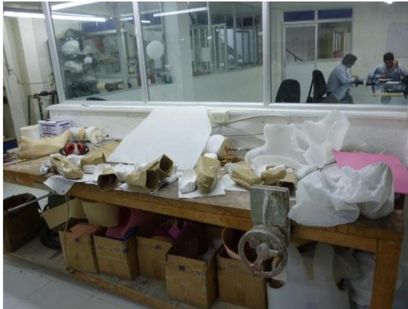
Calentado el forro, se procede a colocarlo sobre el plástico ejerciendo una fuerza sobre el para que este adquiera la forma que se requiere. Luego se procede a aplicar pegamento al forro para adherirlo a este y quede el producto forrado. Finalmente se recorta el sobrante del forro y se limpia.
