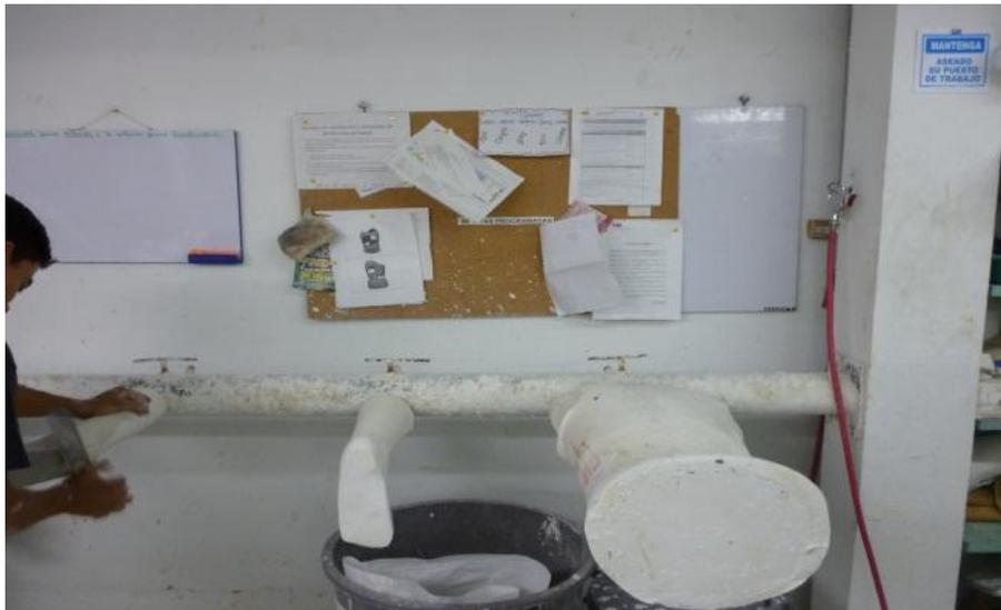
Es necesario tener una pequeña cantidad de mezcla de yeso para corregir ciertas partes del molde. Por último se retira el molde de la base horizontal y se traslada a la zona de laminación o termoformado según el requerimiento.
