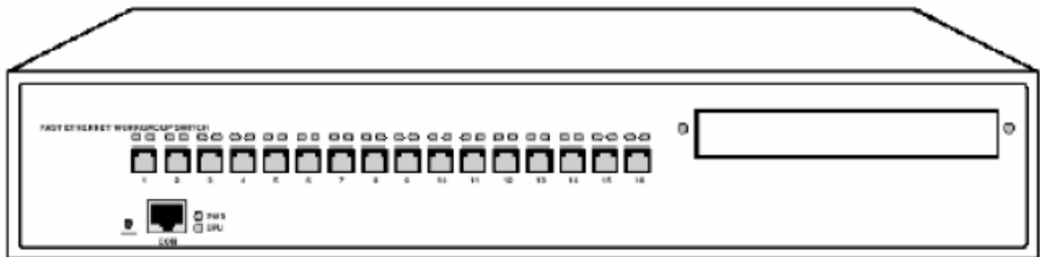
Figura 24. Switch de 16 Puertos.
