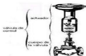
Figura 11 Válvula de Control
