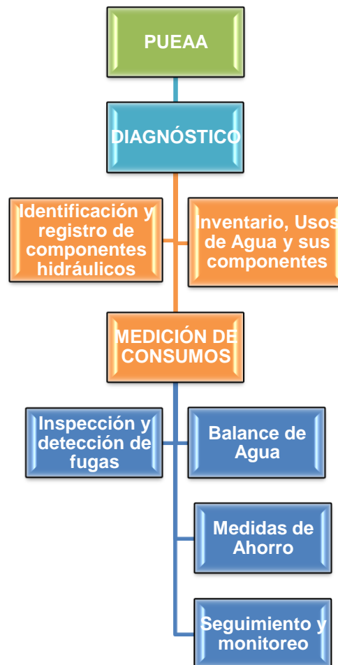
Diagrama No. 2: Proceso realizado para la implementación del Programa de Uso Eficiente y Ahorro de Agua en la empresa FINCA S.A., sede Bucaramanga
