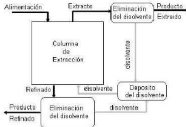
Figura 5. Método por Contacto Diferencial en Contracorriente. [5]
