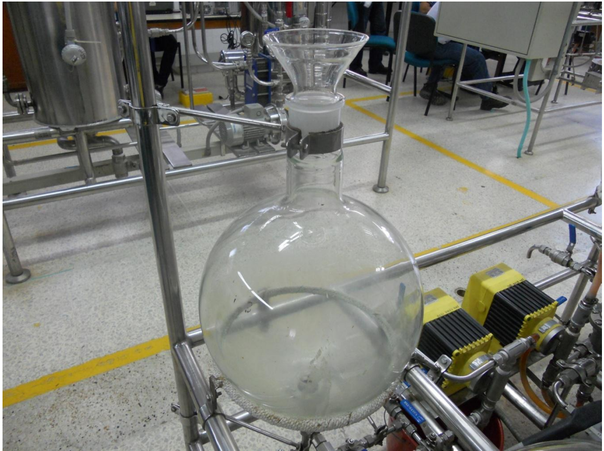
Figura 18. Tanque de Almacenamiento. [14]
