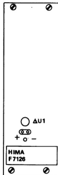
**Figura 19. Fuente Alimentación 5 VDC, F7126**
