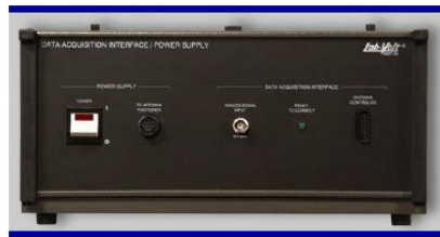
Figura 6-7. Interfaz para adquirir datos [14].
