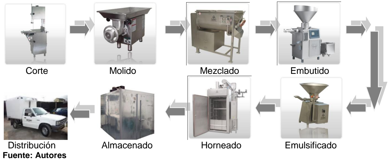
Figura 19. Diagrama de proceso salchichón
