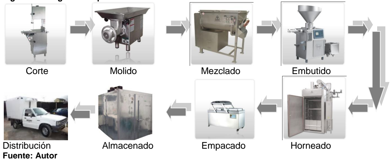
Figura 15. Diagrama de proceso chorizo
