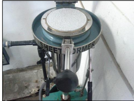
Figura 8. Formador de hojas manual.
