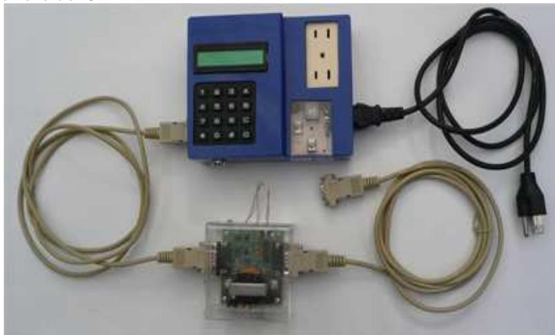
Si los dos dispositivos no conformaran el hardware del SIMEM, entonces lo harían tres tarjetas, cada una de ellas conectadas entre si como lo muestra la figura 15. Dos de ellas se localizan en el dispositivo de monitoreo y cálculo de energía y la otra en el dispositivo de comunicación con el computador. La tarjeta del medidor y la tarjeta de interacción con el usuario se localizan en el dispositivo de monitoreo y
