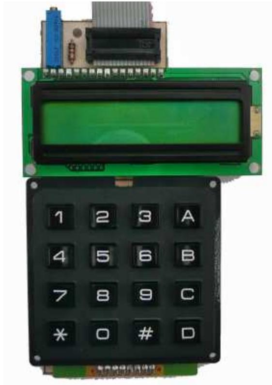
La tarjeta de visualización del usuario permite al usuario interactuar directamente con SIMEM sin la necesidad de que se conecte el computador al sistema. Básicamente esta tarjeta la conforma el LCD, el teclado matricial, y una resistencia variable (ver figura 57). El LCD muestra al usuario mensajes que proyecta el sistema, el teclado toma información del usuario para llevarse al sistema. La resistencia variable configura la intensidad de los mensajes proyectados en el LCD.
