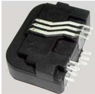
Fotografía del sensor de corriente Honeyweel CSNX25.
