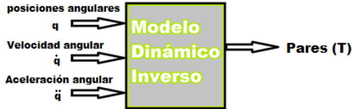
Figura 20 Modelo Dinámico Inverso [1]
