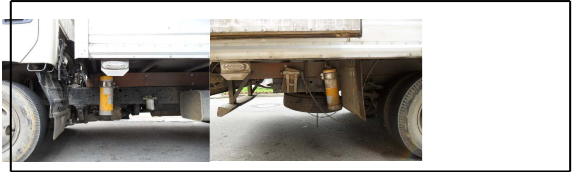
Foto 7. Ubicación de los extintores en el vehículo transportador
