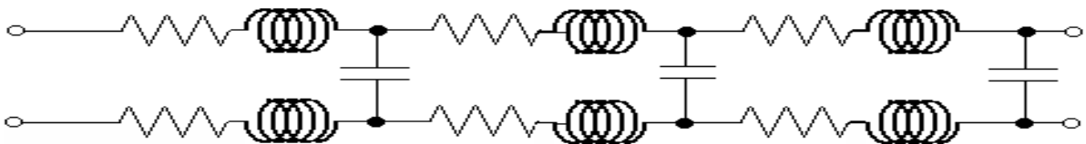
Figura17. Presencia de las Bobinas Pupinizadoras en el circuito de la red de cobre[8]
