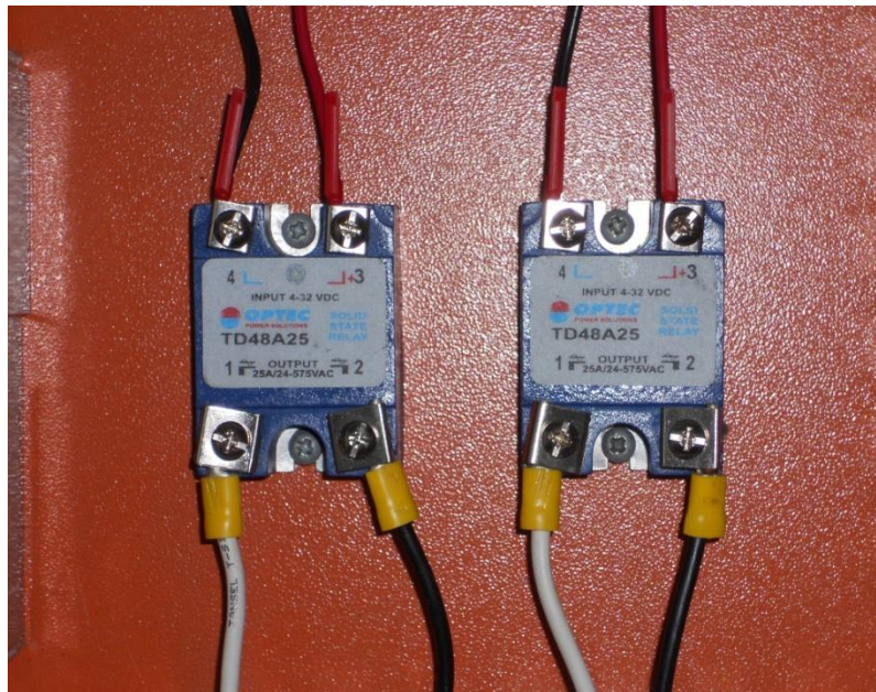
Figura 26. Sistema de acondicionamiento Relés de estado solido. 8
