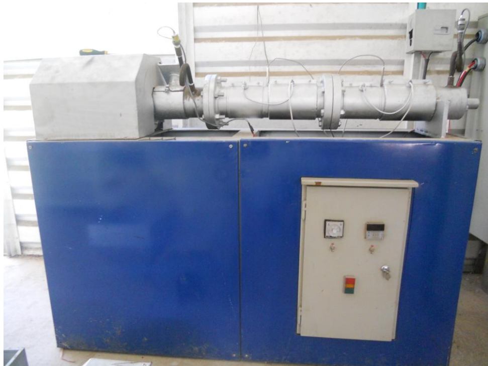
Figura 18. Máquina extrusora con sensores de presión y RTD. 8
