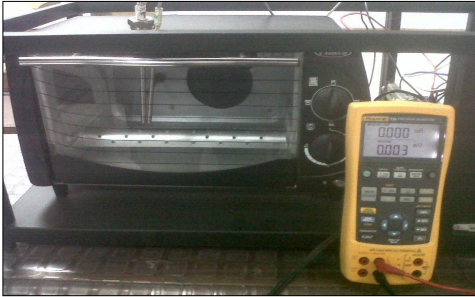
Figura 6. Montaje del experimento para obtener lecturas de temperatura y resistencia con la RTD pt100 tipo 1 Fuente: Autores
