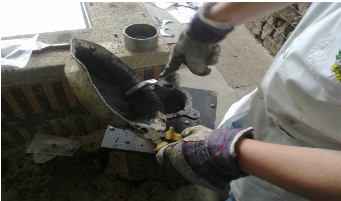
Vertiendo el asfalto con ceniza sobre la mezcla de agregados.
