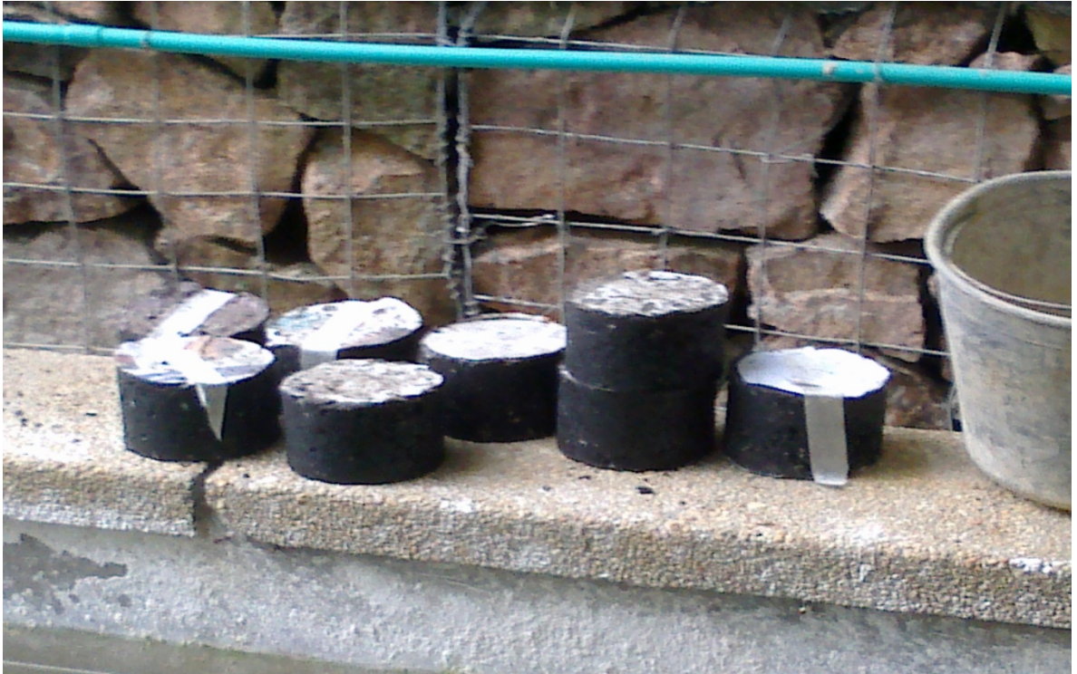
Ensayo de Penetración al Asfalto modificado con la ceniza
