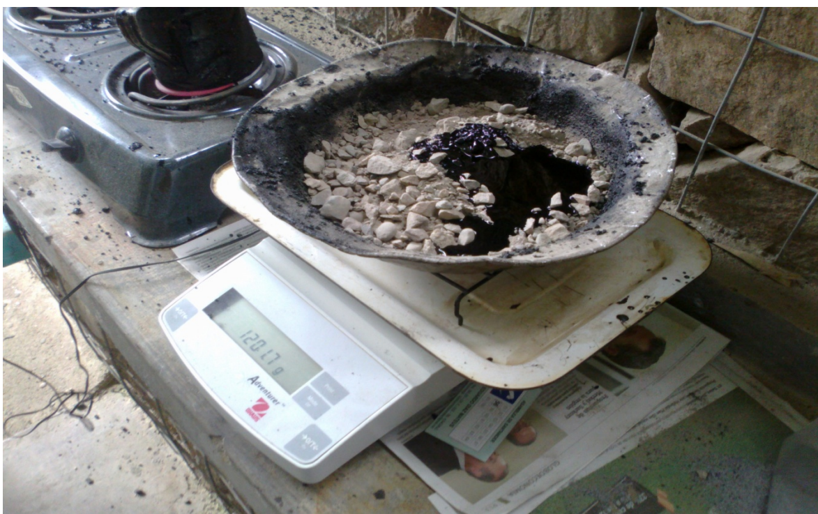
Vertiendo el asfalto con ceniza sobre la mezcla de agregados.
