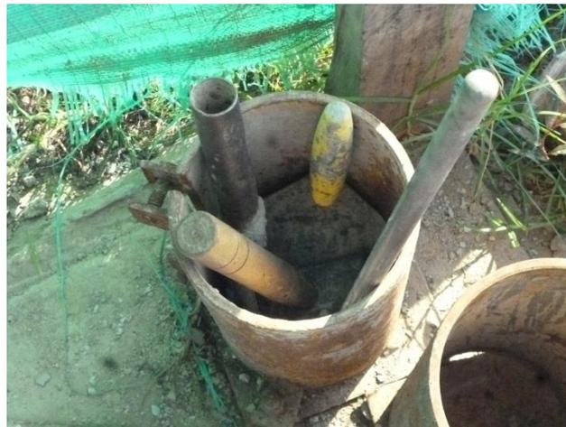
Imagen 18, Equipo necesario para toma de muestras de concreto, Fuente propia
