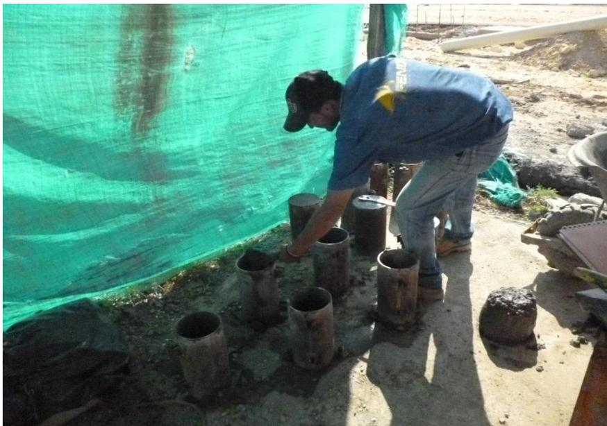
**Imagen 20, Realizando el muestreo del concreto, Fuente propia**
