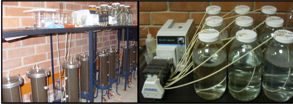
Ilustración 22. Montaje de las Columnas - Bomba Peristáltica.
