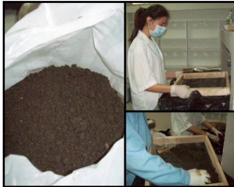
Ilustración 18. Tamizado del suelo contaminada.
