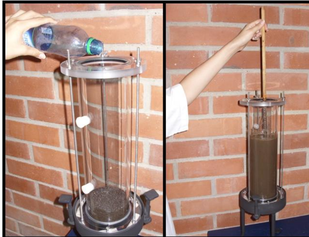
Ilustración 23. Llenado de Columnas con suelo contaminado.
