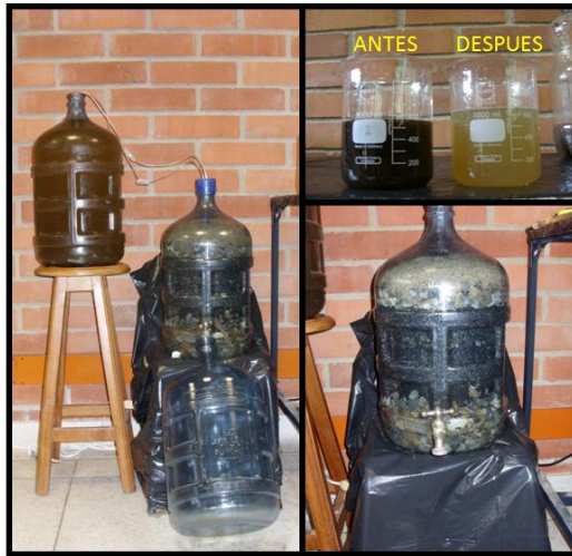
Ilustración 24. Tratamiento para el agua de lavado. -Filtro de Carbón Activado.
