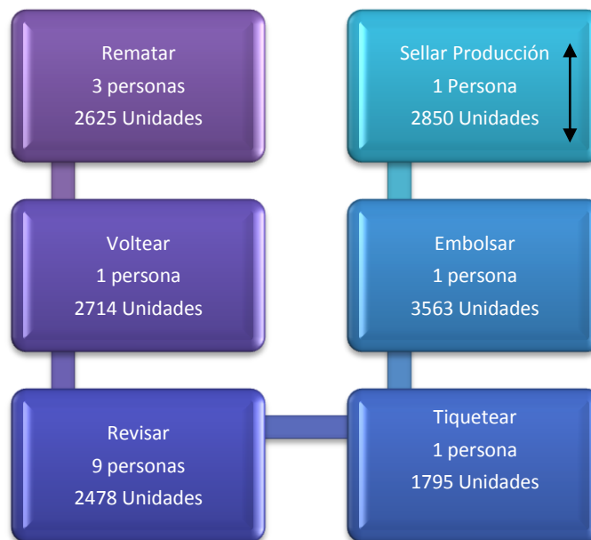
Figura 23. Propuesta capacidad instalada
