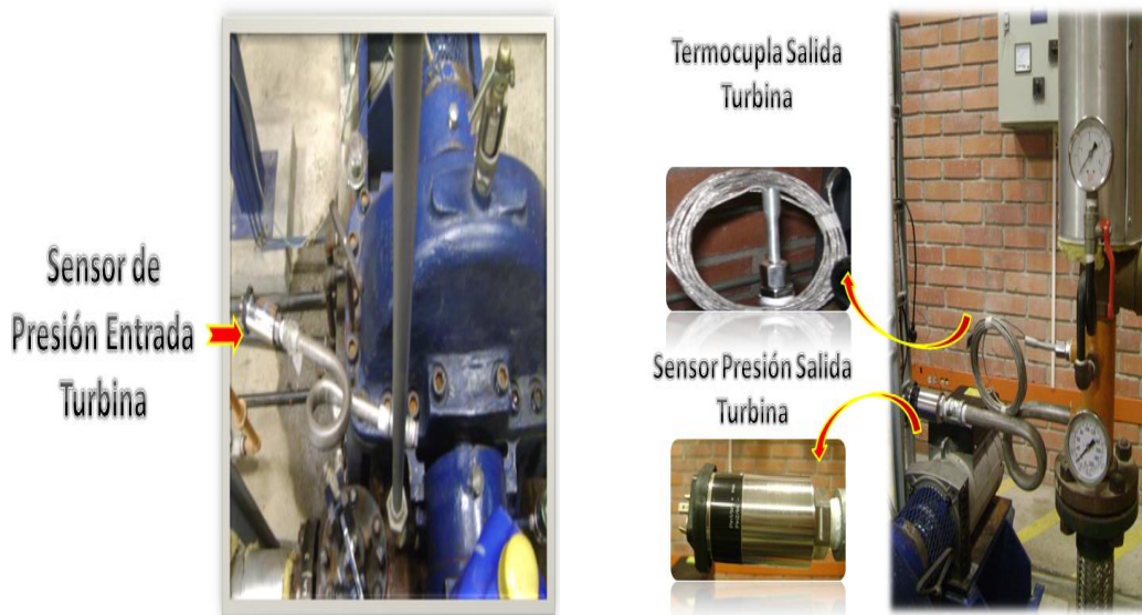
Figura 15. Posicionamiento de sensores en la turbina
