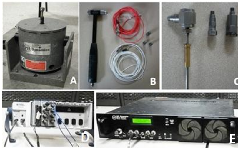
Figura 12 Equipos e instrumentos para ensayo modal en EMA
