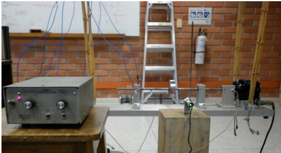
Figura 35. Equipos utilizados para control de velocidad en OMA rotorkit
