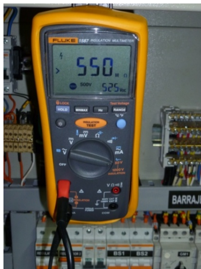
Figura 46. Medida de aislamiento de los conductores [10]
