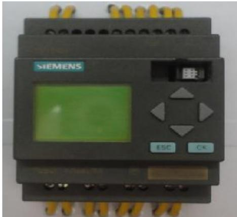
Este tipo de autómatas se distingue por presentar en un solo bloque todos sus elementos: Fuente de alimentación, CPU, memorias, entradas/salidas. Son los autómatas de gama baja o nanoautómatas los que suelen tener una estructura compacta. Su potencia de proceso suele ser muy limitada dedicándose a controlar máquinas muy pequeñas o cuadros de mando. Cuenta con 2 Salidas analógicas, 8 entradas digitales y 4 Salidas digitales.
