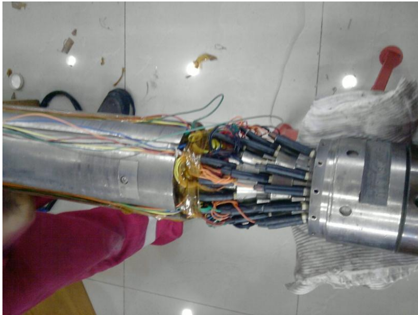
Figura. 49, Cableado de sonda EMI.
