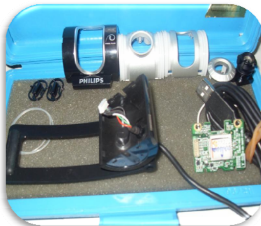
Figura 30. Separación de Carcasas
