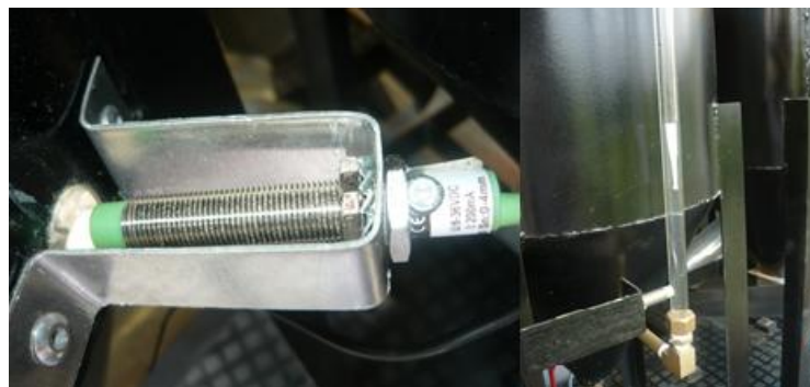
Figura 120. Instalación sensores en el prototipo Fuente Autores
