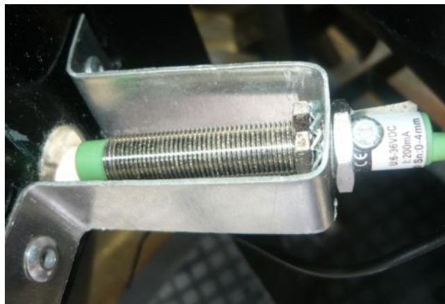
Figura 82. Sensor capacitivo Fuente autores
