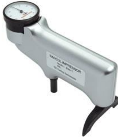
Figura 2.4. Durómetro Barcol para dureza de elastómeros. [21]
