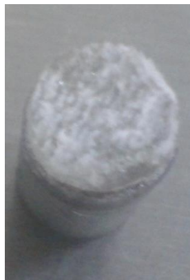
Figura 2.9. Imagen de pin de poliéster insaturado (UP) unido a portapines de aluminio.
