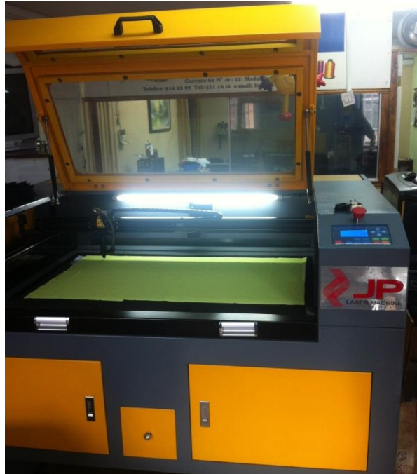
Figura 2.6. Cortadora laser para el corte de pines de poliéster insaturado y contra cuerpos de Acrílico.
