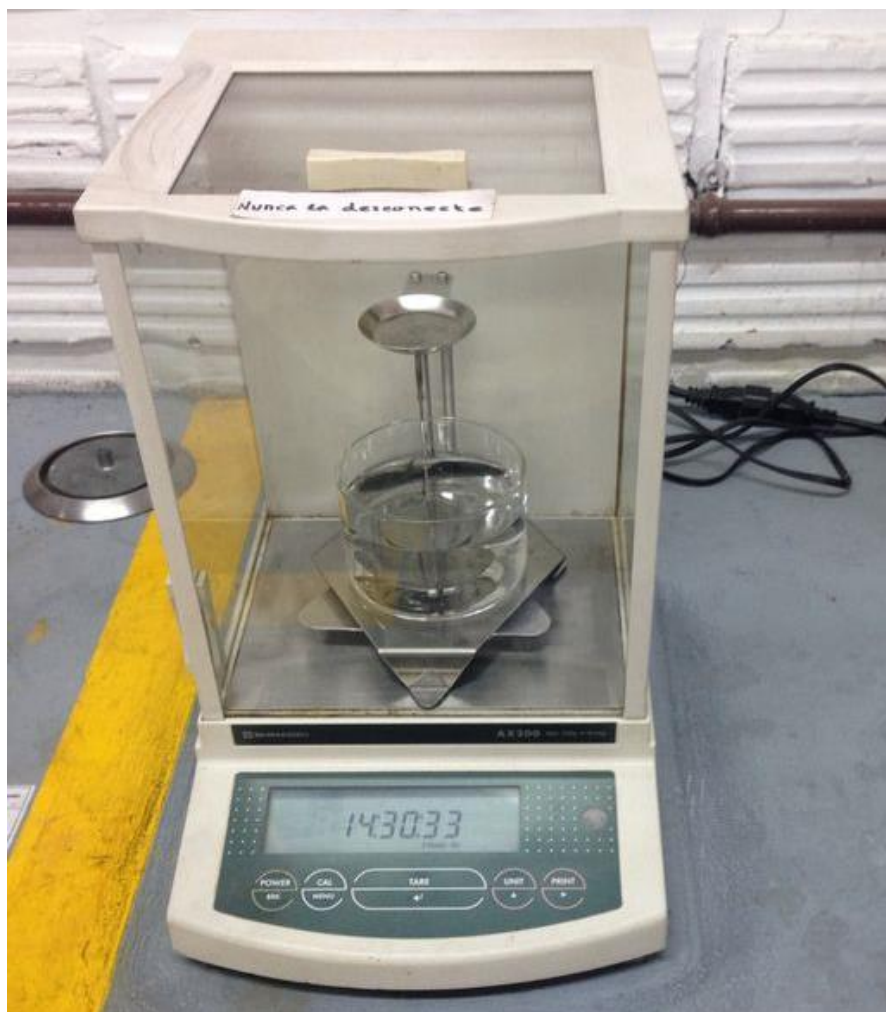
Figura 2.10. Balanza densimétrica para pesos de pines.
