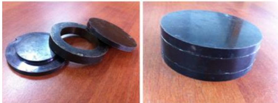
Figura 2.2. Moldes usados para la fabricación de los pines de UP; compresión en caliente.
