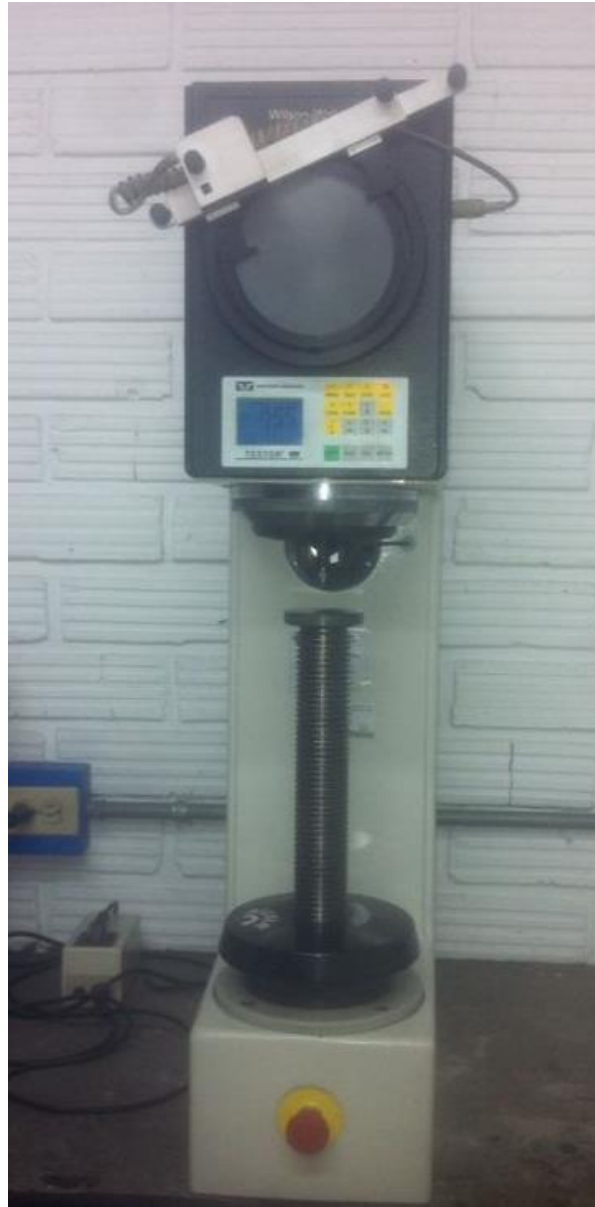
Figura 2.5. Durómetro Rockwell laboratorio de Resistencia de Materiales Universidad Pontificia Bolivariana.
