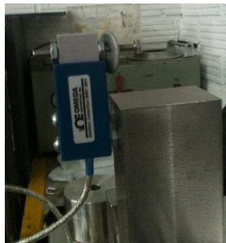
Figura 6.5. Montaje de la celda de carga.
