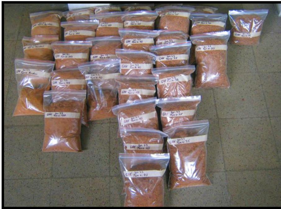
Figura 11. Material obtenido por *Steam Explosion* tamizado y rotulado.
