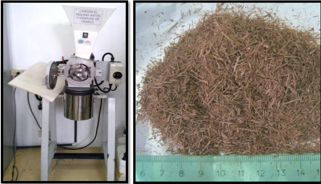
Figura 9. Molino y material molido.
