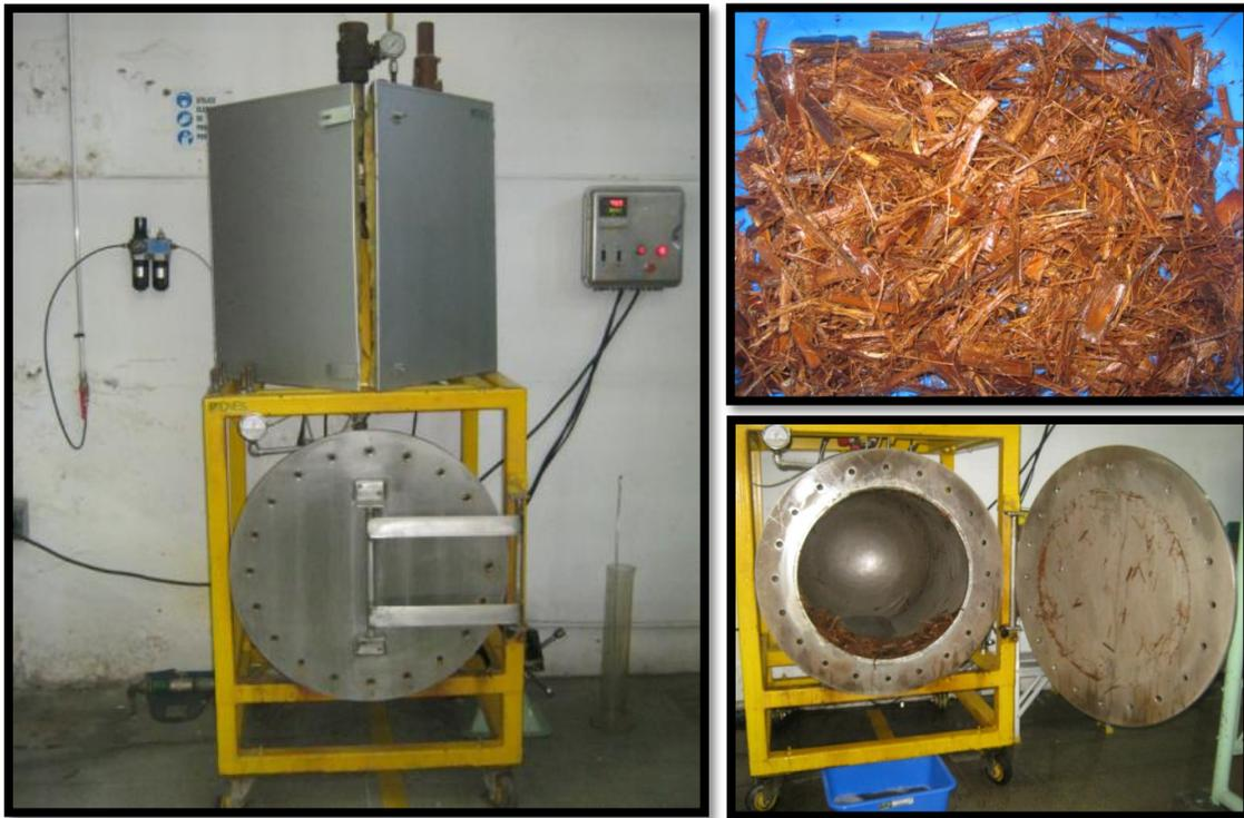
Figura 6. Equipo para tratamiento *Steam Explosion* y material tratado.
