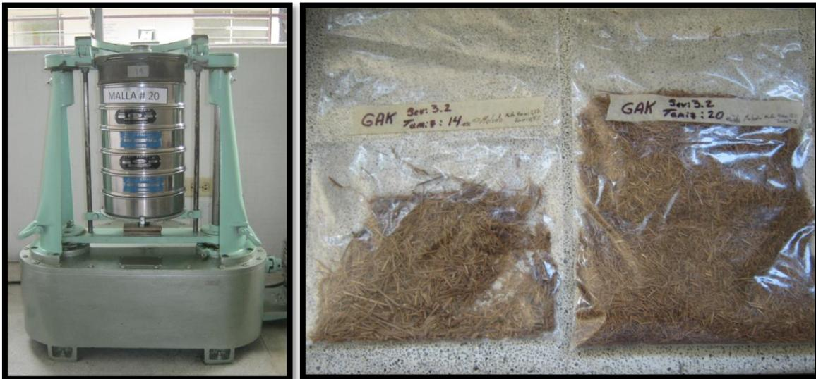
Figura 10. Equipo para tamizado y material tamizado.
