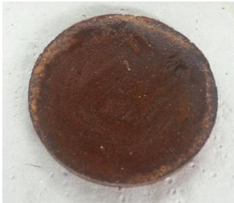
Después de este proceso se observaron varias situaciones en las composiciones como: la probeta final de composición 90-10 presentó una tonalidad más amarilla que el resto de probetas, generalmente la probeta quedaba con mejor acabado y pocas burbujas por la parte de inferior del molde, la parte superior de la probeta quedaba con algunas burbujas.
