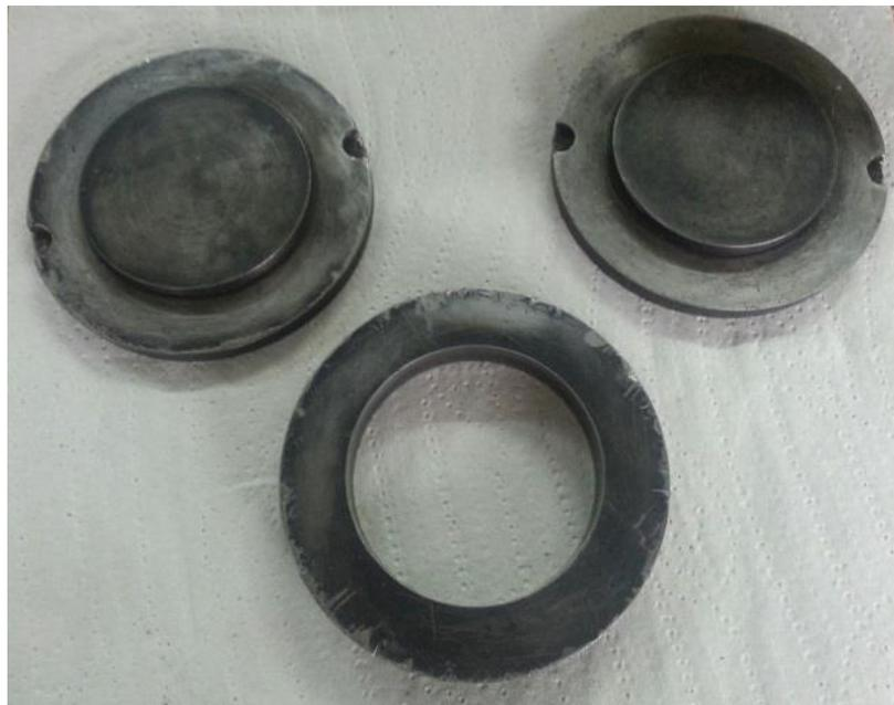
**Figura 6.** Molde usado para sacar probetas para ensayo de flexión.
