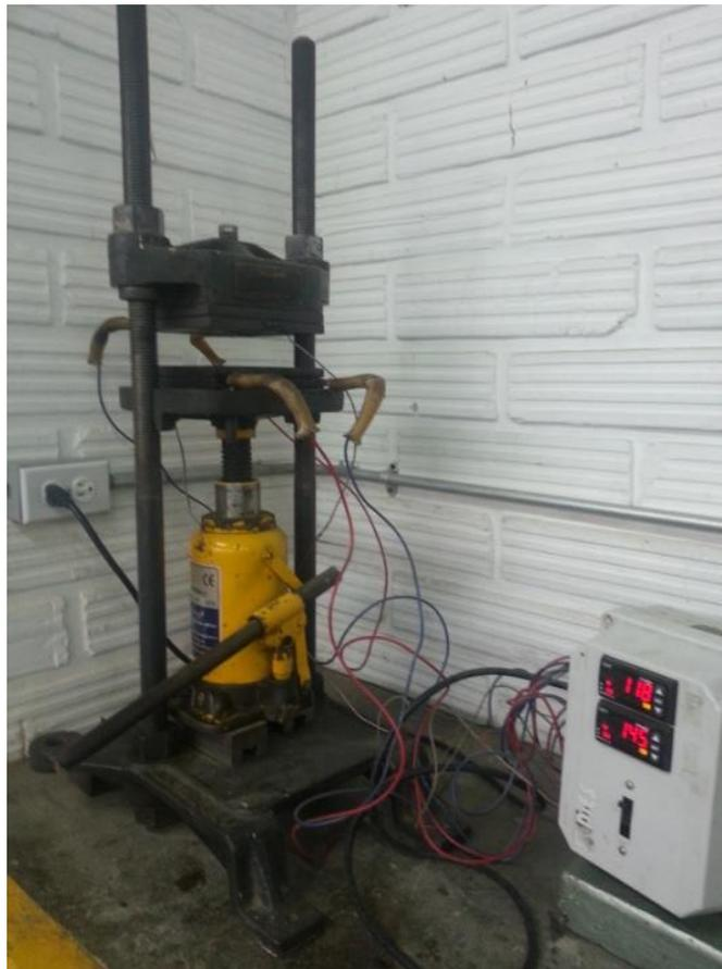
Finalmente después del proceso de compresión en caliente se obtiene la probeta final (Figura 10) del material compuesto, variando el tamaño de partícula con la proporción 70/30 resina/SBR, y variando las composiciones resina/SBR con tamiz #60 a 90/10, 80/20, 70/30, 60/40, 50/50%.
