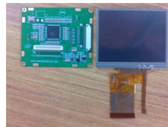
Figura 15. Lcd-tft y board controladora.
