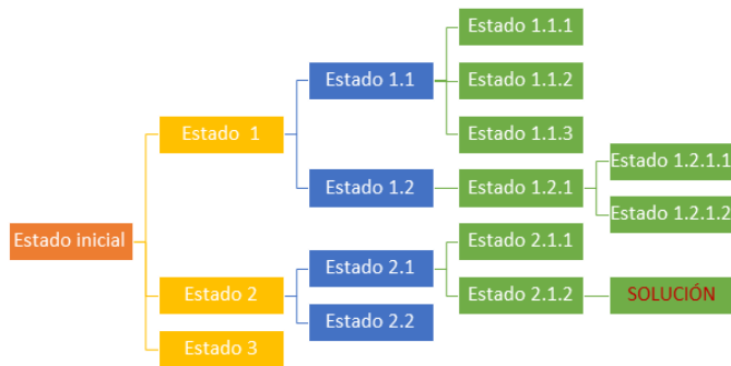
Figura 62. Esquema básico del algoritmo Backtracking
