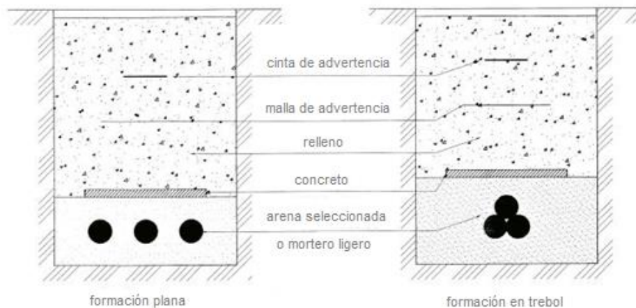
Figura 3. Perfil simple de excavación
