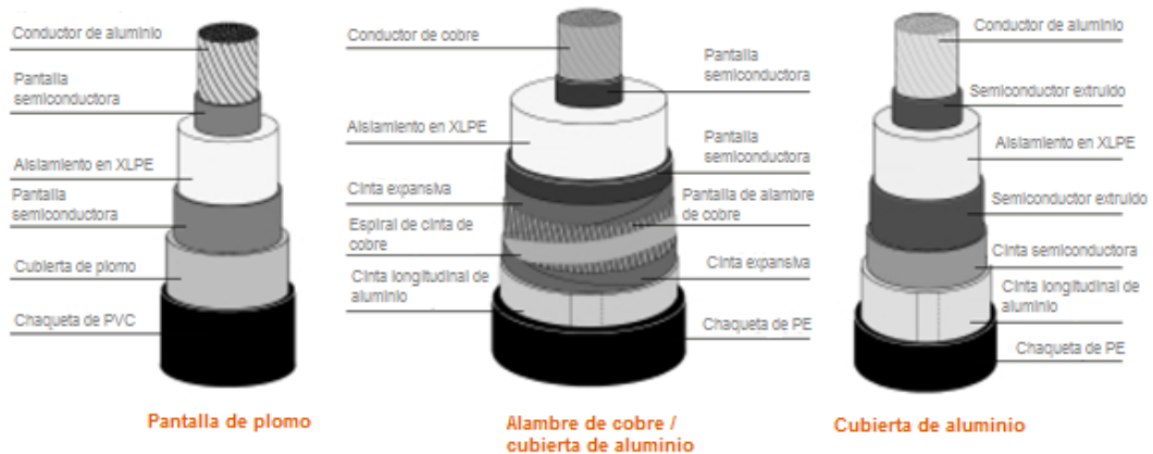
Figura 10. Cables de potencia aislados con diferentes materiales de construcción
