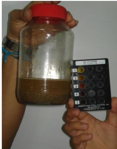
**Figura 5. Comparación con la carta colorimétrica de Gardner**
