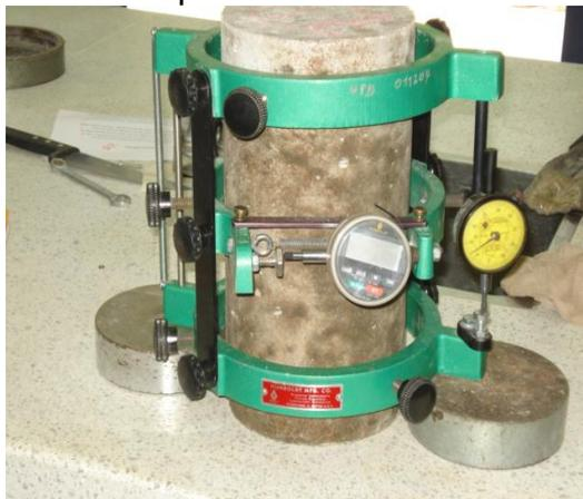
**Figura 18. Cilindro de concreto con el compresómetro**
