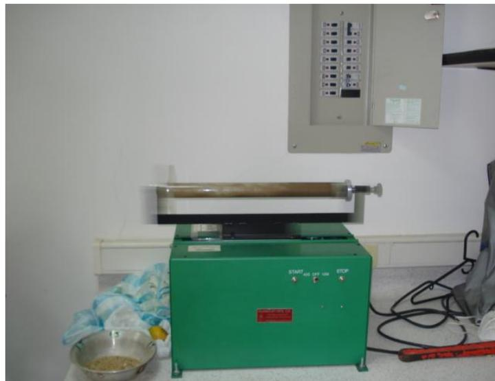
**Figura 12.** Agitador mecánico para el ensayo de equivalente de arena.
