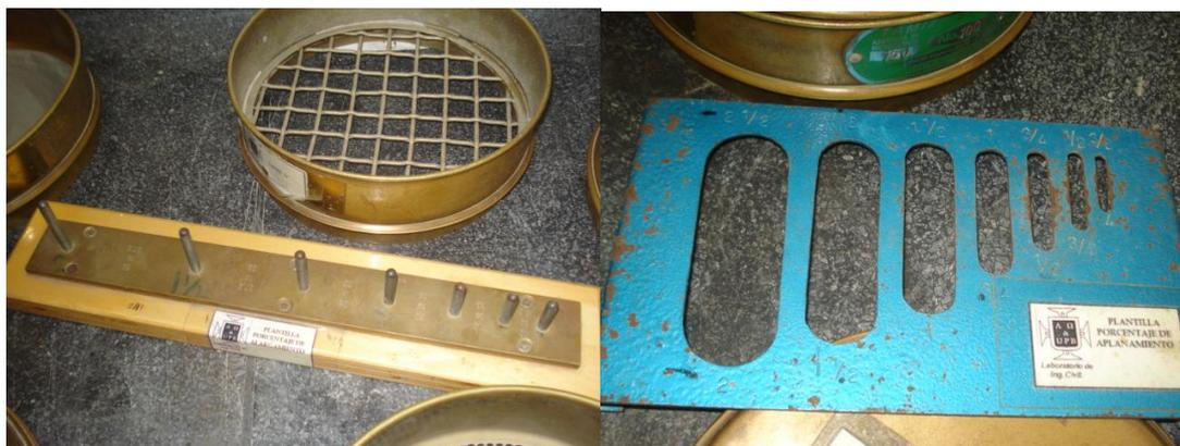
**Figura 14. Calibradores Metálicos de índices de alargamiento y aplastamiento.**
