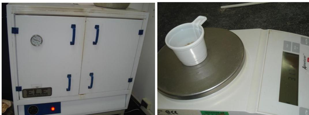
**Figura 11. Horno y Muestra para Humedad.**
