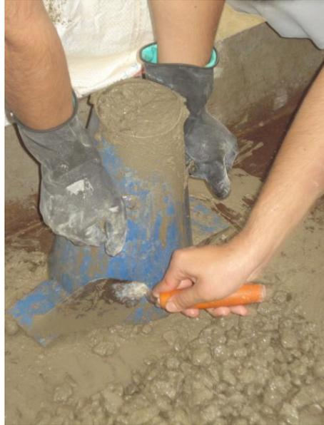
**Figura 15. Ensayo de asentamiento a través del cono de Abrams**
