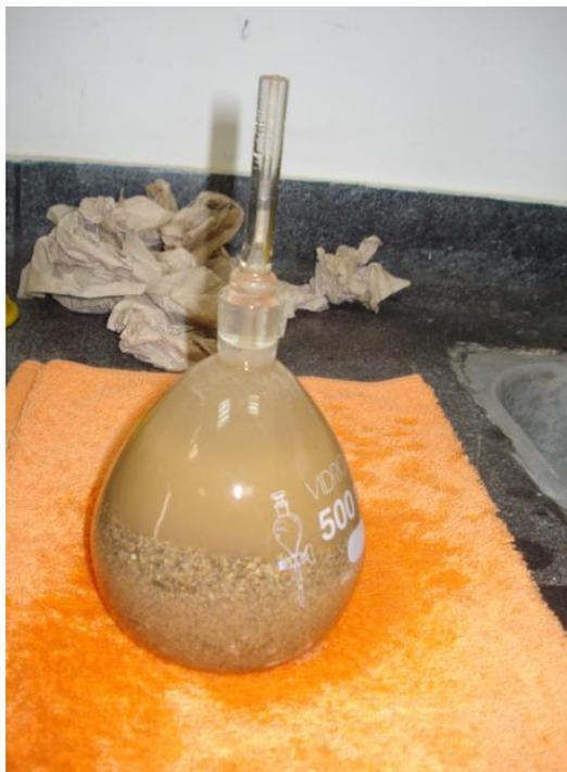
**Figura 6. Picnómetro con la muestra de arena**
