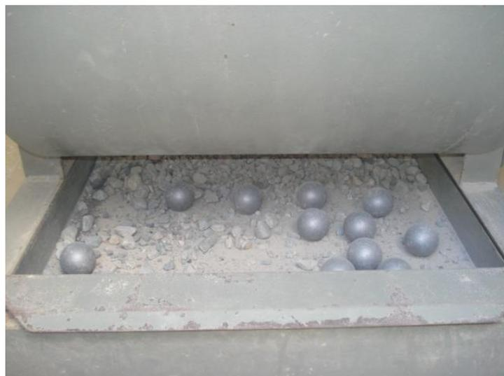
**Figura 8. Esferas de Carga Abrasiva**
