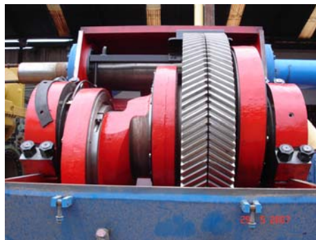
Imagen 7. Relación interna de la Bomba de Lodo Copyright Metalizadora del Oriente. Ltda.
