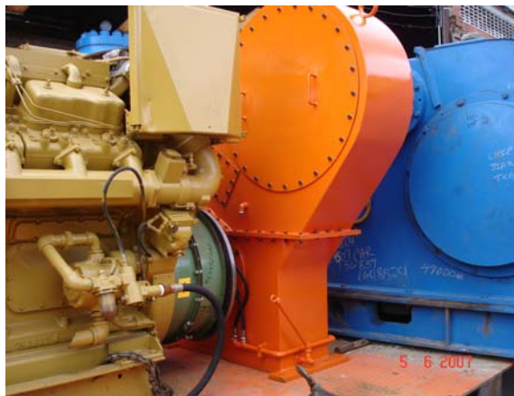
Imagen 11. Ubicación en el Patín del Sistema de Bombeo de Lodo. Copyright Metalizadora del Oriente. Ltda.
